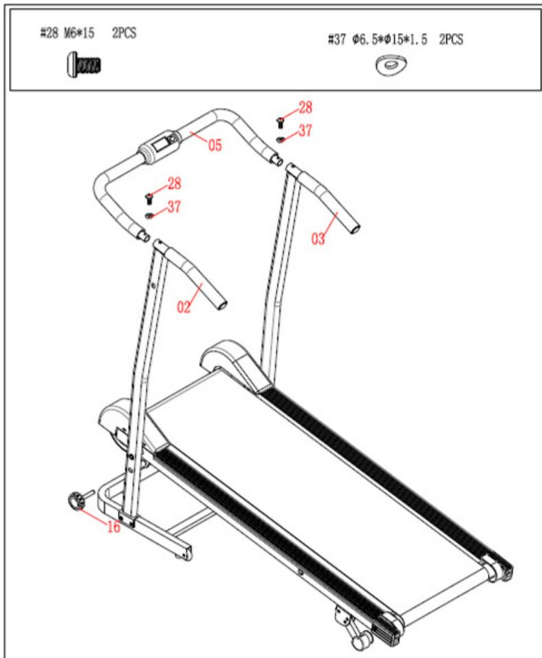
1. Подсоедините к стойкам (02, 03) держатель консоли (05), после чего закрепите его с помощью двух болтов (28) и двух шайб (37).
