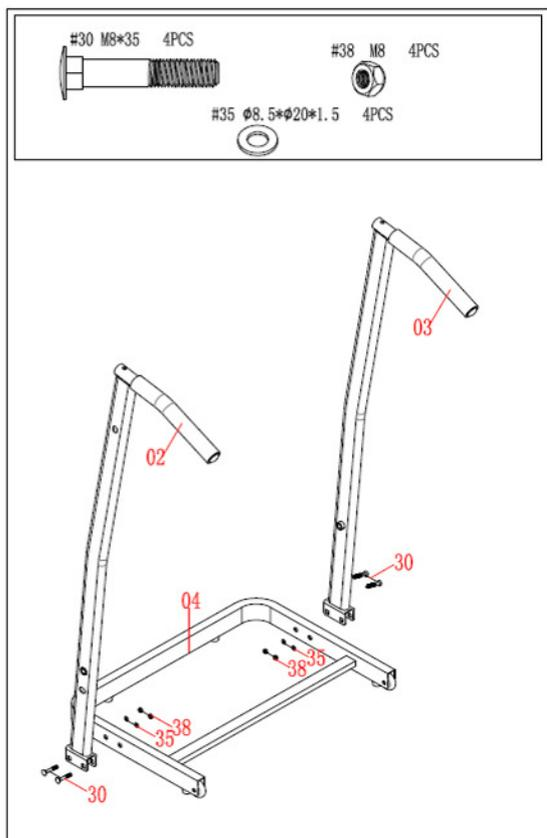
Установите левую (02) и правую (03) стойки на основание (04) тренажёра, закрепите конструкцию с помощью четырёх комплектов крепёжных деталей: болтов (30), шайб (35) и гаек (38).
