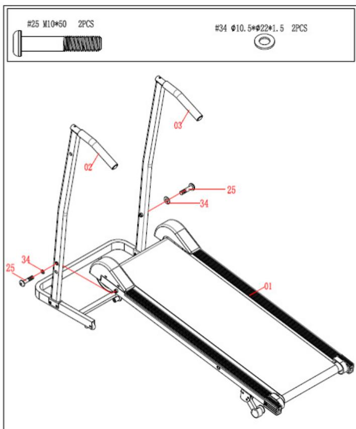
Расположите главную раму (01), между стойками (02, 03), после чего закрепите её с помощью двух болтов (25) и двух шайб (34).
